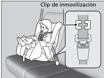
3. Agarre firmemente el cinturón cerca de la hebilla. Mantenga sujetas las dos partes del cinturón para que no se deslicen por la hebilla. Desabroche el cinturón de seguridad.
