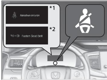
El sistema del cinturón de seguridad incluye un indicador en el panel de instrumentos para recordar al conductor, al acompañante o a ambos que deben abrocharse los cinturones.
