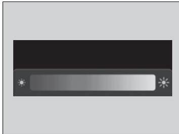
Cuando la modalidad de alimentación está en CONTACTO, puede usar los botones **+** o **-** para ajustar el brillo del tablero de instrumentos.
