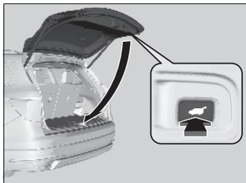
Oprima el botón de la compuerta trasera para cerrar la compuerta trasera eléctrica.
