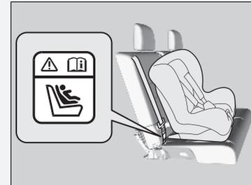
Una vez que el sistema de sujeción para niños esté correctamente instalado, compruebe si el retractor de bloqueo está activado y que el cinturón se retrae y bloquea correctamente. Para desactivar un retractor de bloqueo, libere el enganche y deje que el cinturón de seguridad se enrolle del todo.
