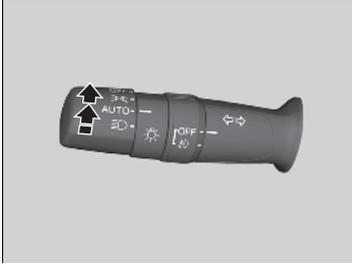
El sistema de luces automáticas se puede utilizar cuando la modalidad de alimentación está en CONTACTO.
