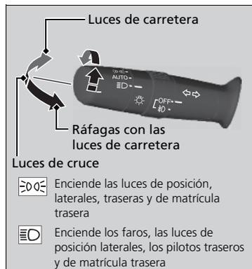
Al girar el interruptor de luces se encienden y apagan las luces, con independencia del ajuste de la modalidad de alimentación.
