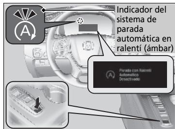
Para desactivar el sistema de parada automática en ralentí, pulse este botón. El sistema de parada automática en ralentí se detiene.
