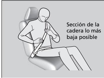
3. Coloque la sección de la cadera del cinturón de seguridad lo más baja posible sobre las caderas, y luego tire hacia arriba de la sección del hombro para que la sección de la cadera quede bien ajustada. De este modo los robustos huesos pélvicos recibirán la fuerza de un impacto, con lo que se reduce el riesgo de que se produzcan lesiones internas.
