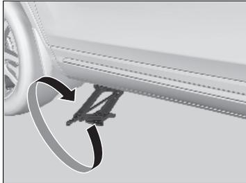
1. Coloque el gato debajo del punto de apoyo más cercano al neumático que va a cambiarse.
