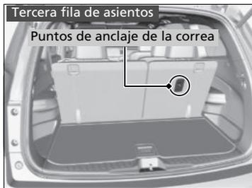
Hay un punto de anclaje para la correa detrás de cada asiento de la segunda y tercera filas. Si dispone de un sistema de sujeción infantil que incluye una correa de sujeción pero que se puede instalar con cinturón de seguridad, puede utilizar la correa para obtener una mayor seguridad.
